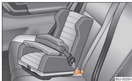
Obr. 166 Dětská sedačka ISOFIX se zasune do montážních krytů
