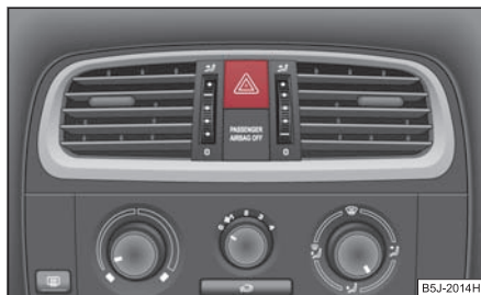
Obr. 52 Přístrojová deska: spínač varovných světel
