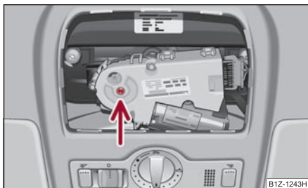
Obr. 47 Výřez z pohledu stropu: nouzové ovládání
