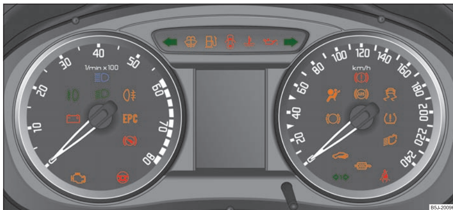
Obr. 30 Panel přístrojů s kontrolními světly
