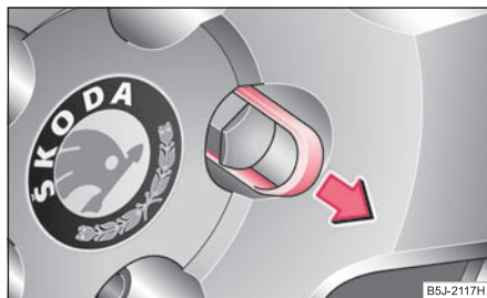
Obr. 195 Výměna kola: sejmutí krytky ze šroubu kola
