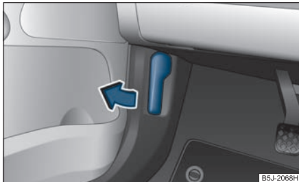
Obr. 178 Páčka odjištění vika motorového prostoru
