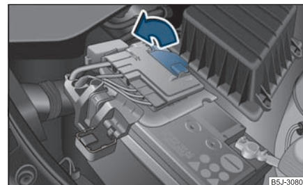
Obr. 186 Akumulátor: odklopení krytu (mechanická převodovka)
