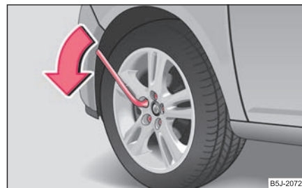
Obr. 196 Výměna kola: povolení šroubů
