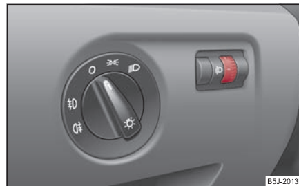
Obr. 51 Přístrojová deska: nastavení sklonu světlometů
