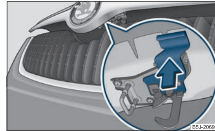
Obr. 179 Mřížka chladiče: pojistka
