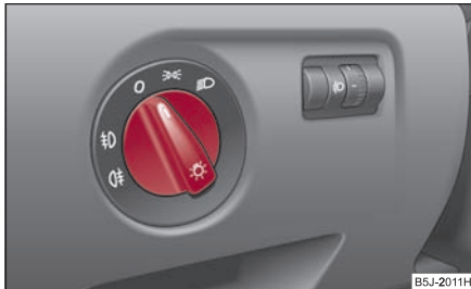
Obr. 48 Přístrojová deska: spínač světel
