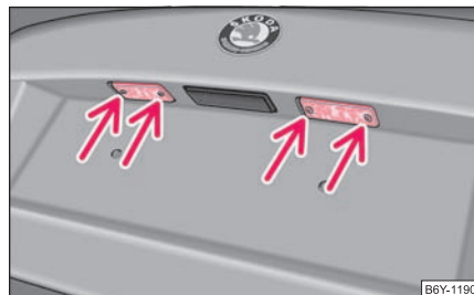
Obr. 215 Demontáž osvětlení registrační značky
