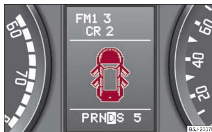
Obr. 27 Informační displej: signalizace otevřených dveří
