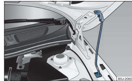
Obr. 180 Zajištění vika motorového prostoru vzpěrou
