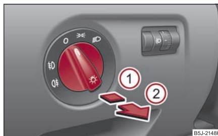
Obr. 50 Přístrojová deska: spínač světel
