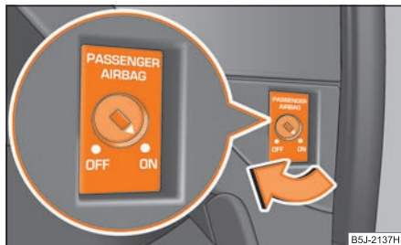
Obr. 156 Vypínač airbagu(ů) spolujezdce
