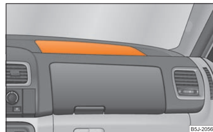
Obr. 149 Airbag spolujezdce v přístrojové desce
