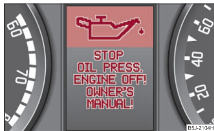
Obr. 28 Informační displej: nízký tlak oleje
