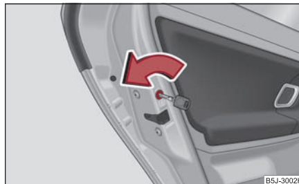
Obr. 35 Dětská pojistka zadních dveří
