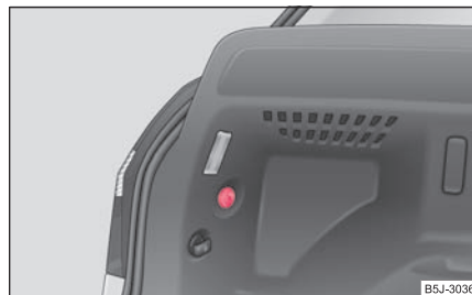
Obr. 216 Demontáž zadní skupinové svítilny
