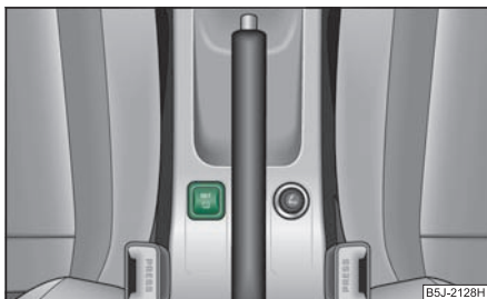
Obr. 171 Spínač nastavení kontrolní hodnoty tlaku v pneumatikách
