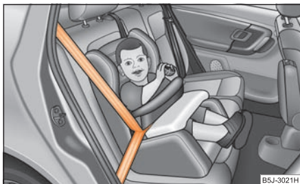
Obr. 162 Dětská sedačka skupiny 1 s bezpečnostním stolem na zadním sedadle po směru jízdy
