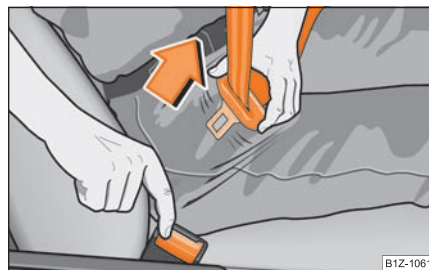
Obr. 147 Uvolnění jazýčku pásu ze zámku
