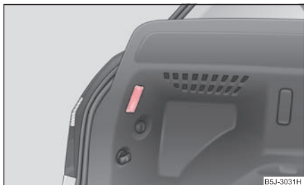
Obr. 219 Demontáž osvětlení zavazadlového prostoru
