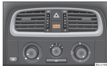
Obr. 157 Kontrolní světlo vypnutého airbagu spolujezdce
