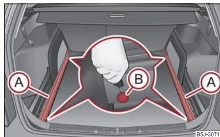
Obr. 83 Zavazadlový prostor: uvolnění pojistných bodů
