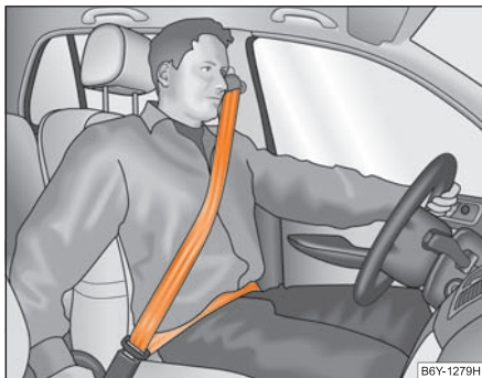
Obr. 144 Průběh ramenního a pánevního pásu
