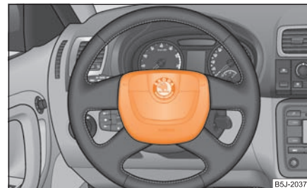
Obr. 148 Airbag řidiče ve volantu
