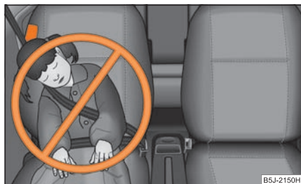
Obr. 159 Nesprávně zajištěné dítě na sedadle v poloze, ve které je ohroženo bočním airbagem
