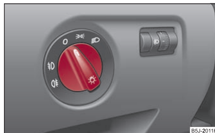
Obr. 8 Přístrojová deska: spínač světel
