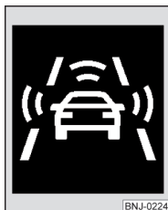
Obr. 146 Displej v panelu přístrojů: předběžné varování, resp. nouzové brzdění v nízké rychlosti
