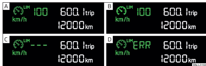
Obr. 138 Segmentový displej: příklady zobrazení stavu omezovače rychlosti
