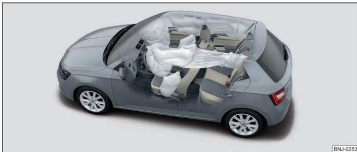
Obr. 8 Plynem naplněné airbagy
