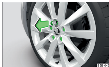
Obr. 182 Stažení krytky šroubu kola
