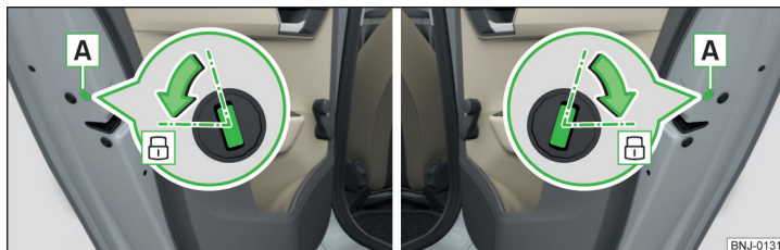
Obr. 194 Nouzové zamknutí: zadní dveře levé/pravé
