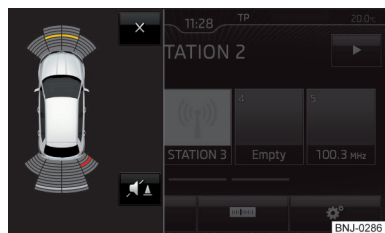
Obr. 131 Displej infotainmentu: zobrazení při automatické aktivaci
